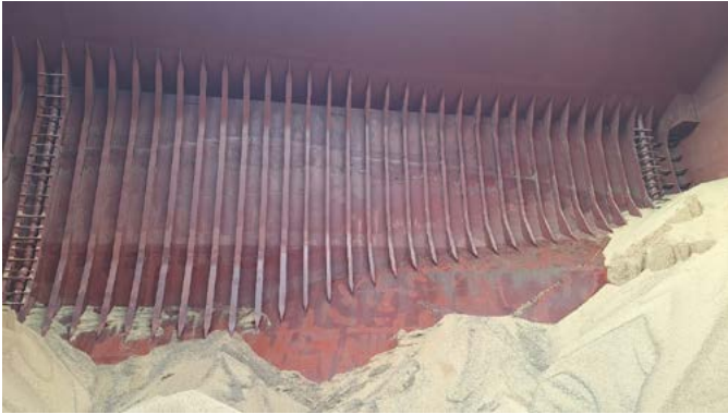
図7 ホールド側面のフレームに残っているカビの生えた貨物。カビで表面が固くなっている。
