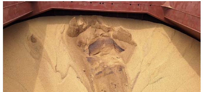
図5 熱損傷した層が見られる大豆貨物。中央の黒っぽい層は他の種類の穀物や異物が大量に含まれているため、積地で既に汚染されていたロットが積まれたものと思われる。
