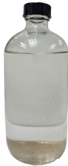
10分間の フラッシング後に 採取したサンプル - 色が薄くなっている
