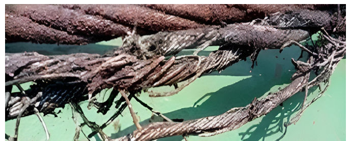
破損したクレーンワイヤ
