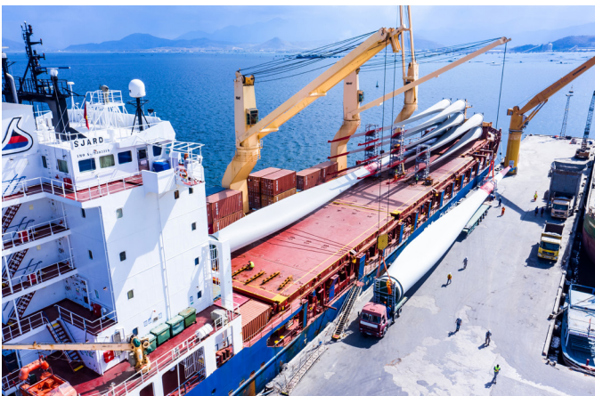
風力タービン用ブレードをクレーン2基でタンデムリフトする様子
