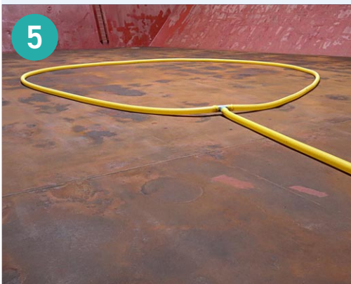
圖5: 於貨艙內進行燻蒸作業使用的黃色管路
