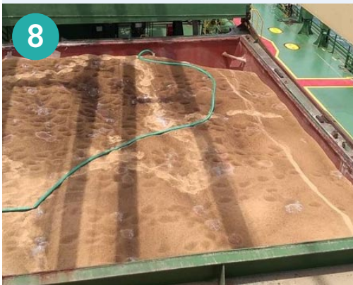
圖8：燻蒸造成爆炸後的貨物表面和所使用的再循環管路
