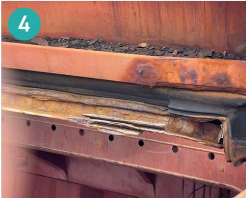
圖4：位於十字接頭和緣圍上的排水道不應有雜物。橡膠墊片應排列整齊，以維持艙蓋的風雨密度完整性。
