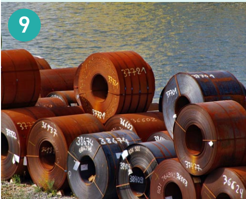
圖9：無包覆的熱軋鋼捲(HRC)，由於這類鋼捲經常會暫時放置於室外，有輕微生鏽實為常見，惟如圖所示，可見大多數的鋼捲已嚴重生鏽，此為不能接受的。
