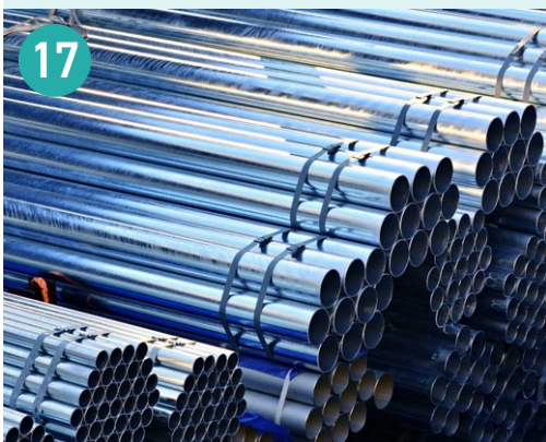
圖17：鋼管通常會細綁在一起，末端特別容易受損。
