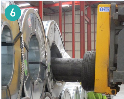
圖6：應詳實記錄於岸上發生的裝卸毀損，註明鋼材是否受損，或是僅外罩受損。
