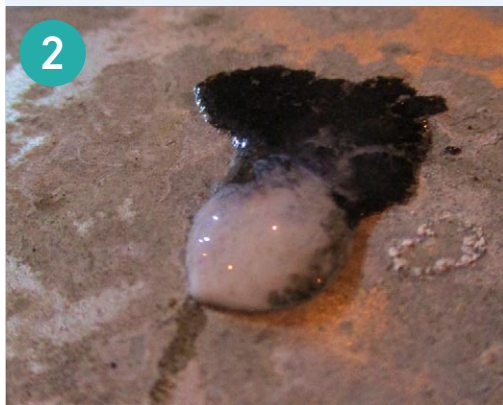
圖2：硝酸銀溶液接觸到氯化物時，會從透明色轉變成乳白色。
