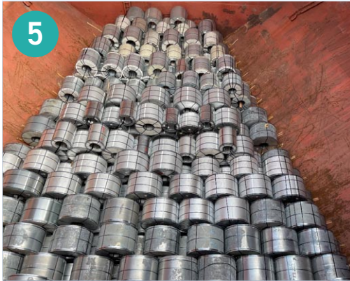
圖5：船尾貨艙的形狀導致在貨物積載與繫固上更具挑戰。
