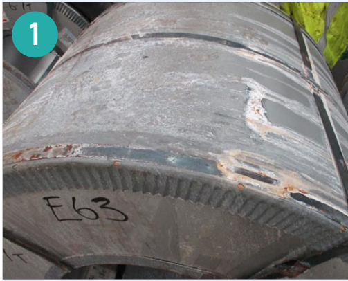
图1：海水渗入造成冷轧钢卷(CRC)致外罩毁损。
