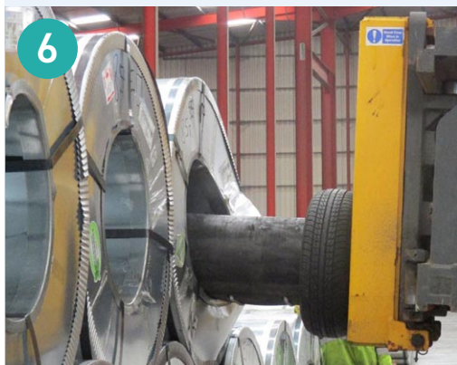
图6：应详实记录于岸上发生的装卸毁损，注明钢材是否受损，或是仅外罩受损。
