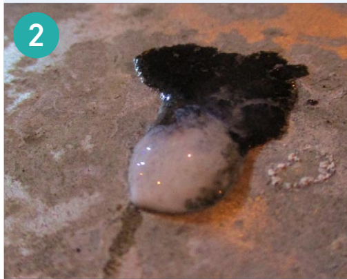
图2：硝酸银溶液接触到氯化物时，会从透明色转变成乳白色。
