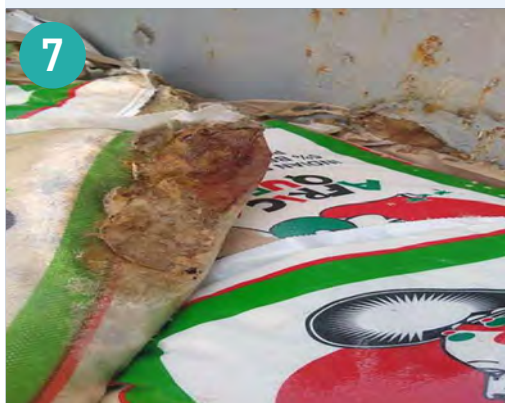
写真7: 構造部材と接して積まれていたためにカビが生え、接していた部分だけが変色してしまった貨物。 CWAより許可を受けて転載
