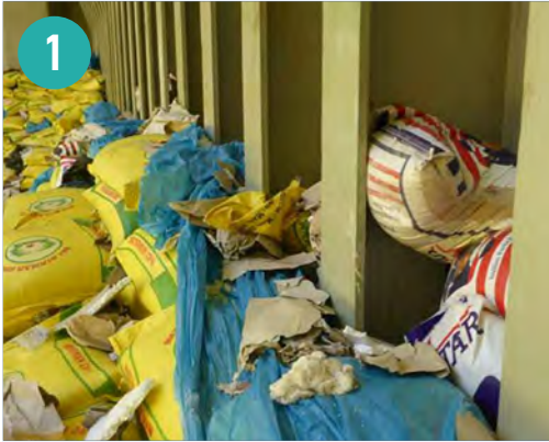
写真1: 揚地でのダンネージ資材の様子。航海中に貨物が動いて、資材がフレームの間に入り込んでしまった。CWAより許可を受けて転載
