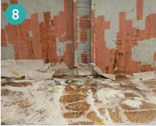
写真8: 荷揚げ中、タンクトップに敷かれていたクラフト紙に染みついた袋や水濡れの跡。 CWAより認可を受けて転載
