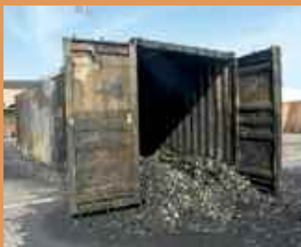
Descarga de un contenedor de carbón vegetal mostrando cómo su fuego puede reiniciarse con salida de residuos por su fondo.
